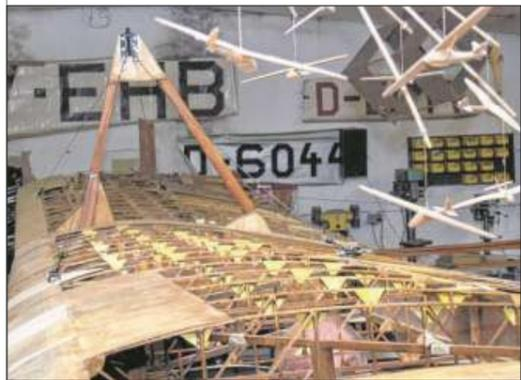
Die Tragflächen des SG-38 wurden noch nicht bespannt. Der filigrane Innenaufbau aus Holz ist gut zu erkennen.
